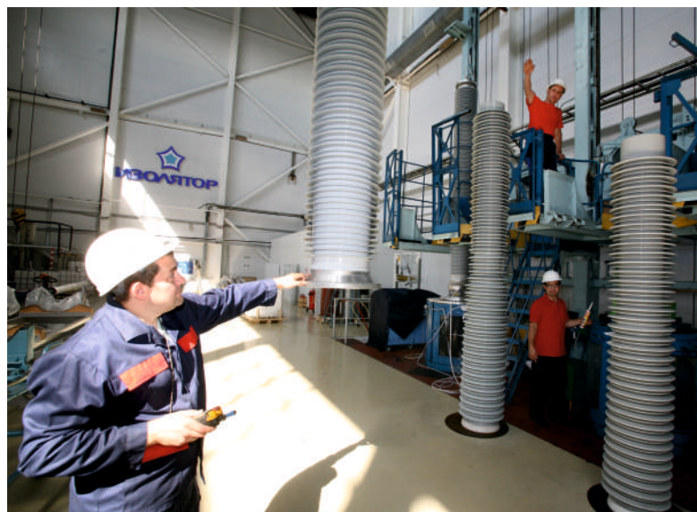
图 20. “莫斯科绝缘”厂装配架上的 500kV、330kV 套管
