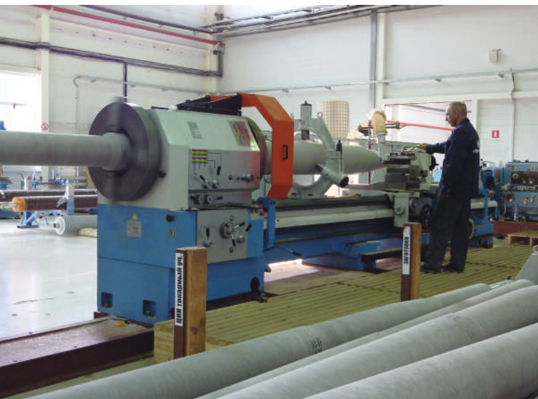
图 19. “莫斯科绝缘”厂内 500kV RIP 绝缘车床加工
