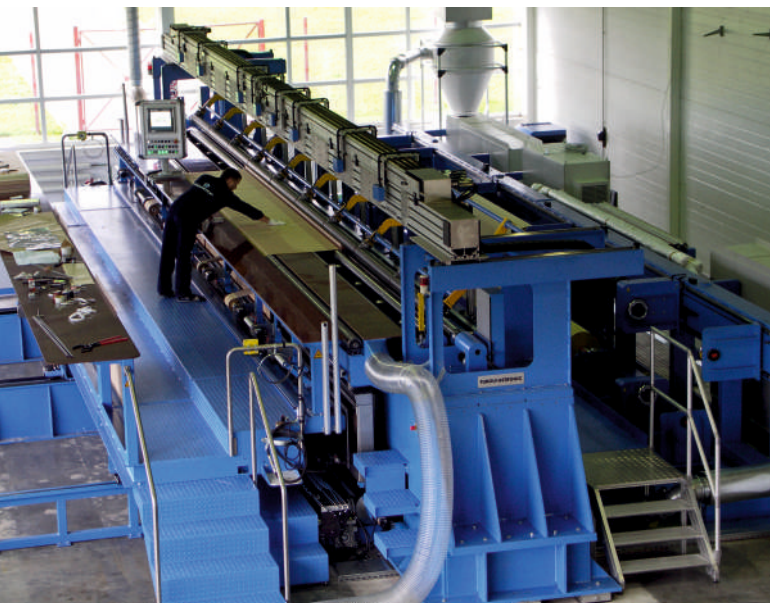
图 17. 高度自动化的 220-1150kV 绝缘纸缠绕机
