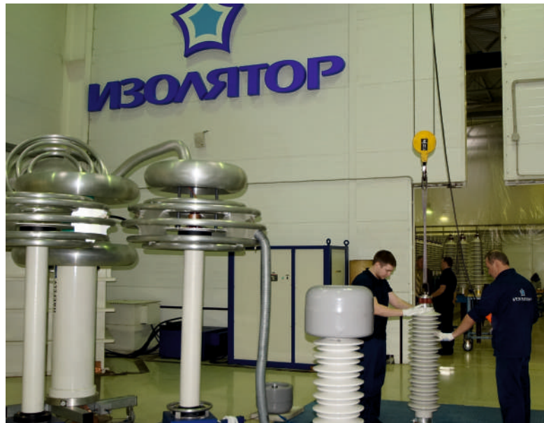
图 35. “莫斯科绝缘” 厂内 110kV 套管电气试验
