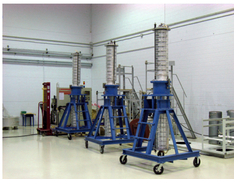
图 22. “莫斯科绝缘”厂内用于制造复合外绝缘的 Hilger u. Kern 公司的浇铸成型机。
