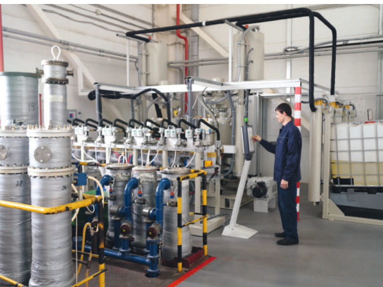
图 18. “莫斯科绝缘”厂内 Hubers 绝缘真空浸渍机
