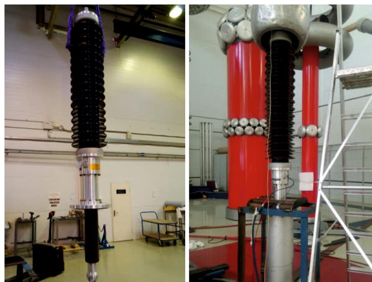
图19. 试验中的«SF6-空气»RIP绝缘套管
