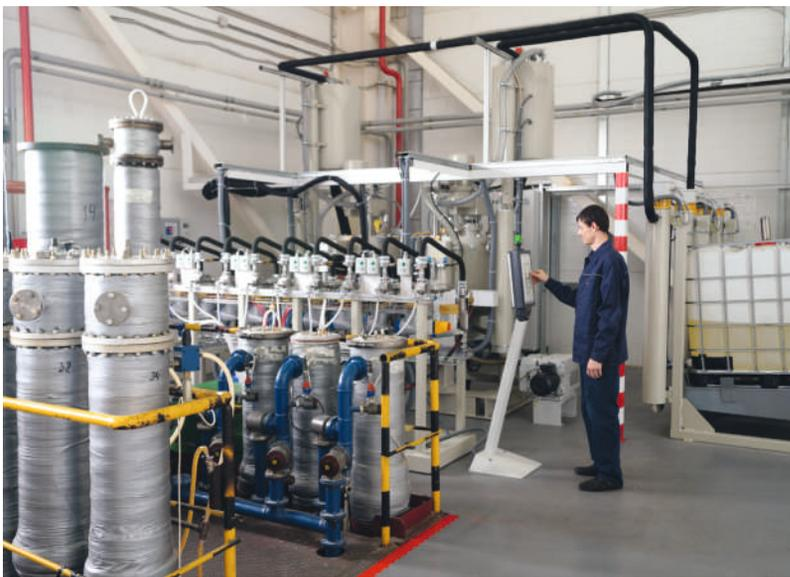
图16. “莫斯科绝缘”厂内Hubers绝缘真空浸渍机
