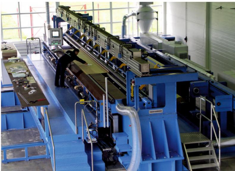
图15. 高度自动化的252-1150 kV 绝缘纸缠绕机
