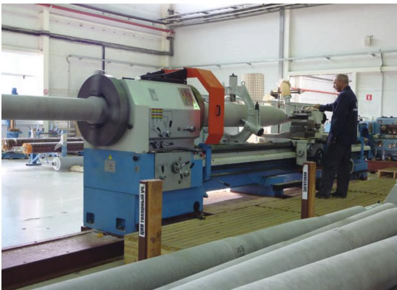
图17. “莫斯科绝缘”厂内550kV 绝缘车床加工
