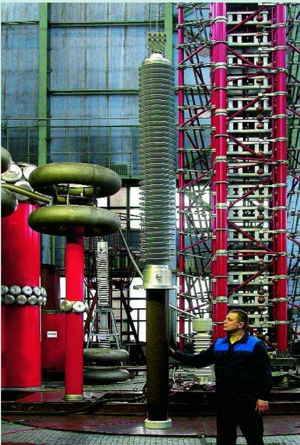
Рис. 3. Трансформаторный ввод 220 кВ с полимерным оребрением в высоковольтной лаборатории
