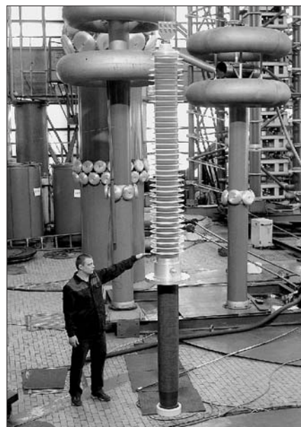
Рис. 3. Высоковольтный ввод 220 кВ с внутренней RIP и внешней полимерной изоляцией на испытаниях
