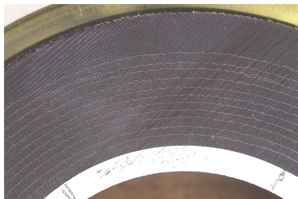
Остов ввода 110кВ производства «Изолятор»
