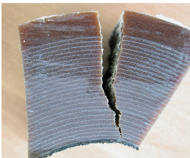
Остов ввода 220кВ производства фирмы HSP
