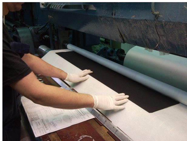
Рисунок 3 – Намотка RIN-изоляции полимерным нетканым полотном с обкладками из электропроводящего материала
