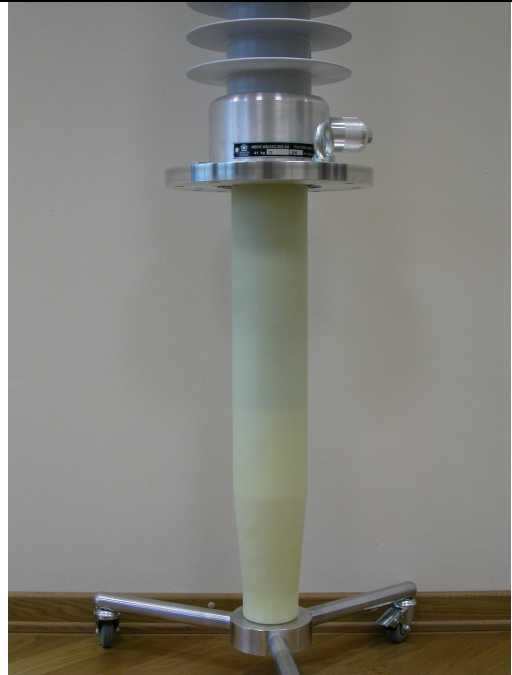
Рисунок 5 – Фрагмент собранного ввода с основной RIN-изоляцией и внешней силиконовой изоляцией
